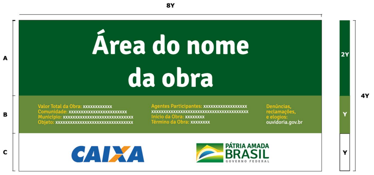
Figura 01 – Detalhe placa da obra
