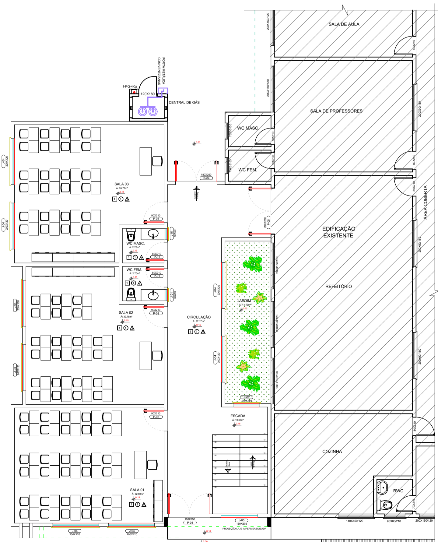
IMPLANTAÇÃO - PLANTA LAYOUT PAVTO TÉRREO Escala: 1/100 Área = 167,96m²
