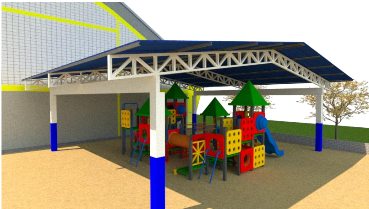
Imagem 01: Cobertura em telhas de aluzinc TP40 0,50mm
